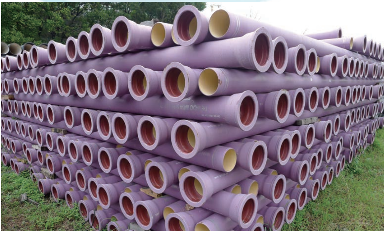
再生水管外觀為紫色，方便與其他管道區分。
