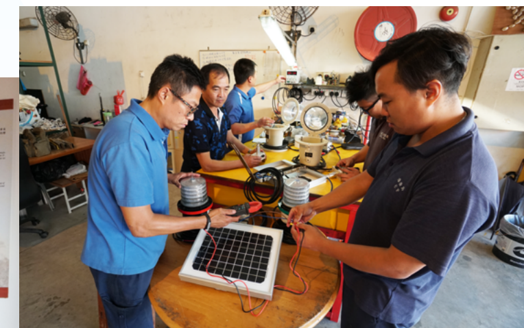
與團隊進行航標燈測試 Realizando um teste de luz das bóias de sinalização com a equipa
