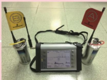
澳門自來水股份有限公司人員探測管網漏水
